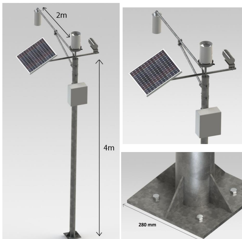
Figura 2 - Visão em perspectiva com cotas principais da estrutura do conjunto de ferragens para instalação da PCDHidro.
