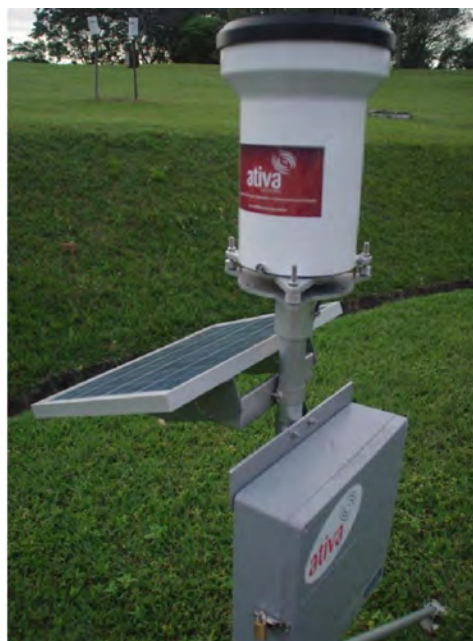
Figura 1 - Imagens da PCD pluviométrica CEMADEN e seus componentes.
