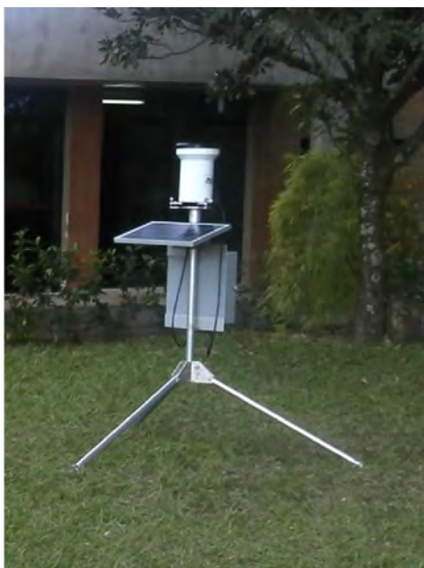
Figura 1 - Imagens da PCD pluviométrica CEMADEN e seus componentes.
