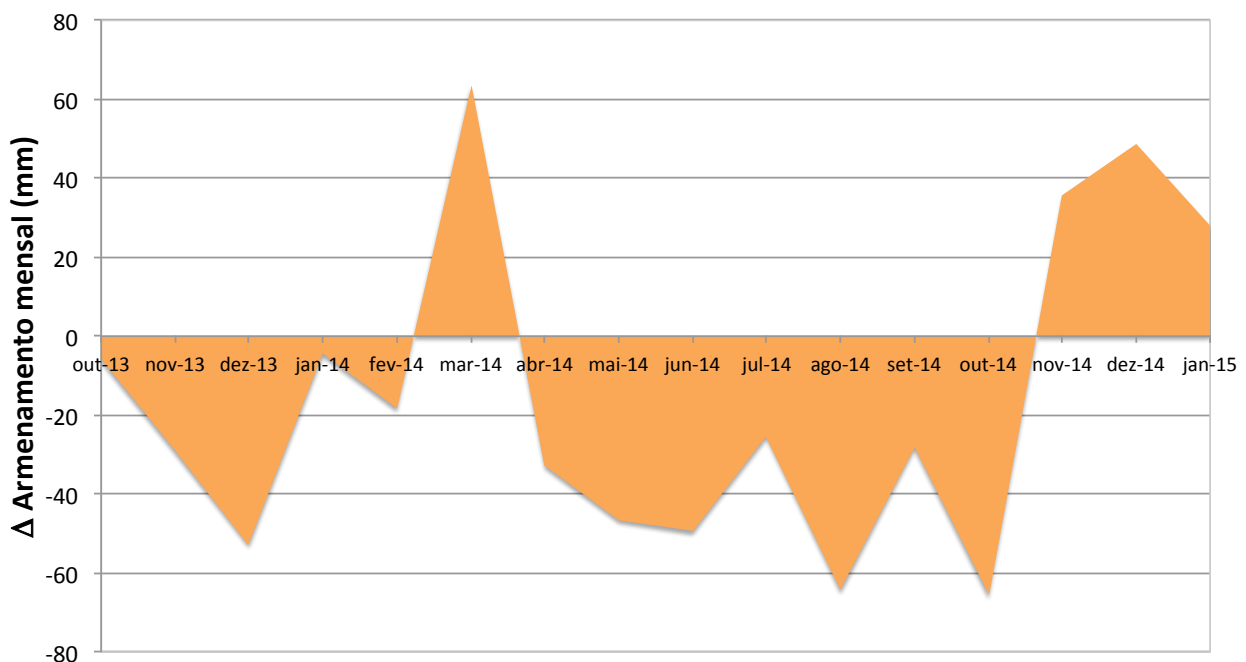
Figura 3. Variação média mensal do armazenamento de água no solo (em mm) para as sub-bacias do Sistema Cantareira). O valores negativos indicam déficit de água no solo.
